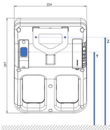
**La cota Z** es la altura desde el suelo hasta los orificios para instalar el soporte.
