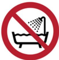
Dieses Sicherheitssymbol weist darauf hin, dass das Gerät nicht in oder in der Nähe von Badewannen, Duschen oder mit Wasser gefüllten Behältern verwendet werden darf.
